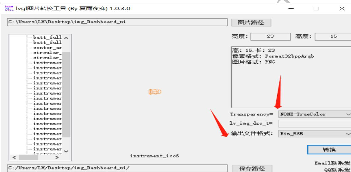
图 1-1 lvgl 图片转换工具配置信息
